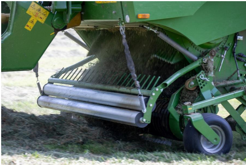
Afb.: Gelijkmatige oplegdruk door mechanische pick-up-ontlasting.
