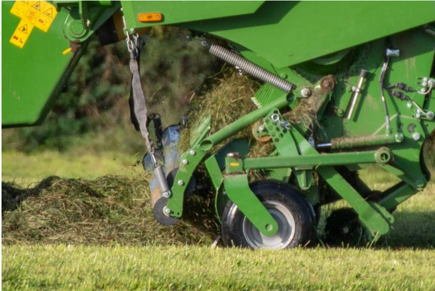
Afb.: Storingsvrije materiaalstroom door nieuwe ophanging van de zwadrollen.
